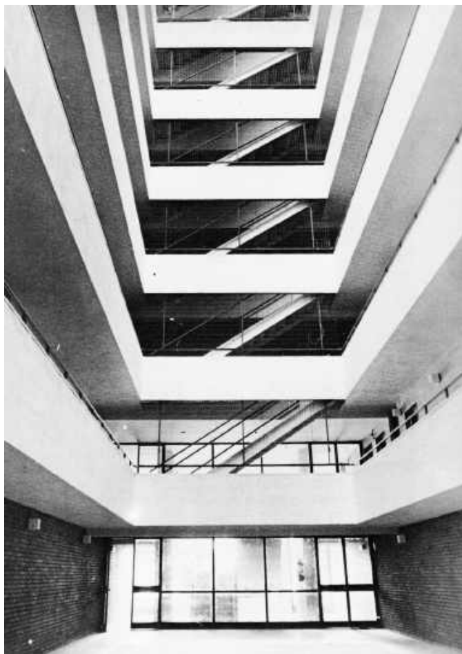
Patio interior cubierto: izquierda, vista hacia la cristalera de acceso, derecha, vista hacia los ascensores. Se aprecian las galerías de acceso a las viviendas y a través de las cuales ventilan las estancias interiores. Fotos: Arquitectura. Nº 237, 1982 y de Iago Somoza
